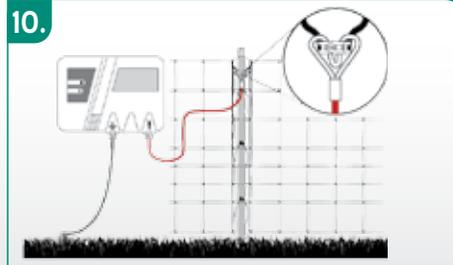
10. Wenn möglich verbinden Sie das Zaunanschlusskabel des Gerätes mit dem Metallclip. Es kann aber auch an jeder anderen Stelle des Netzes an der oberen Litze befestigt werden.
