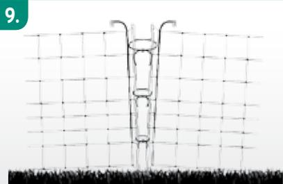
9. Wenn Sie einen Kreis bilden, verbinden Sie den Anfangs- und Endpfahl mit den Fixierbändern. Zusätzlich verbinden Sie die beiden Metallclips miteinander.
